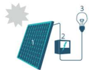
1. Zonnepaneel | 2. Omvormer | 3. Elektrische toestellen
